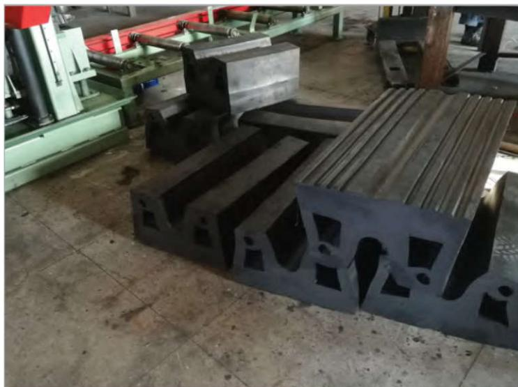
W-образные отбойные устройства для буксиров предназначены для экстремальных условий эксплуатации. Их уникальная конструкция с «открытыми каналами» упрощает установку. Благодаря гибким опорам они прилегают к бортам различной формы.
