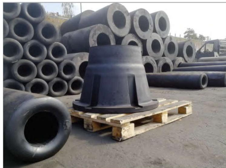
Конусные отбойные устройства (кранцы) принадлежат к последнему поколению отбойников, сочетающих в себе отличные энергетические мощности с низкой реакционной силой, что позволяет осуществить эффективное функционирование отбойного устройства любого типа. Коническая форма кранца держит корпус стабильно при сочетании всех осевых, сдвиговых и угловых нагрузок, что делает его идеальным для пристаней, где должны быть учтены причаливания углами и прочие сложные воздействия.
